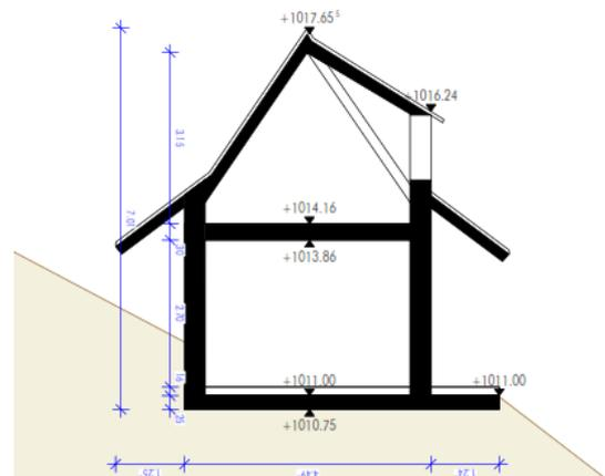
Abb. 11: Schnitte durch die beiden geplanten Typen der kleinen Ferienwohnungen (Quelle: Architekturbüro Sennrich & Schneider, Stand Juni 2023)
