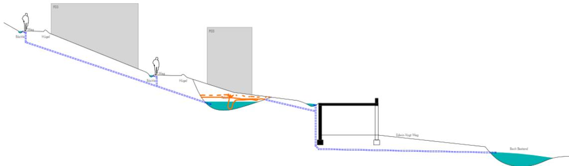
Abb. 16: Schematischer Schnitt zur geplanten Entwässerung mit Rückhalteteichen und wegebegleitenden Rinnen (Quelle: Sennrich & Schneider Architekten, Stand Oktober 2024)
