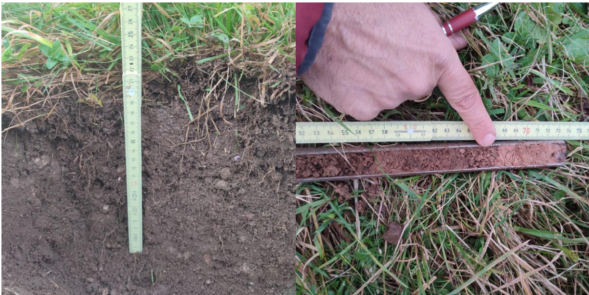
Braunerde mit durchschnittlich 30 cm Ah-Horizont und nur im Oberhang stellenweise auch Cv-Horizont.
